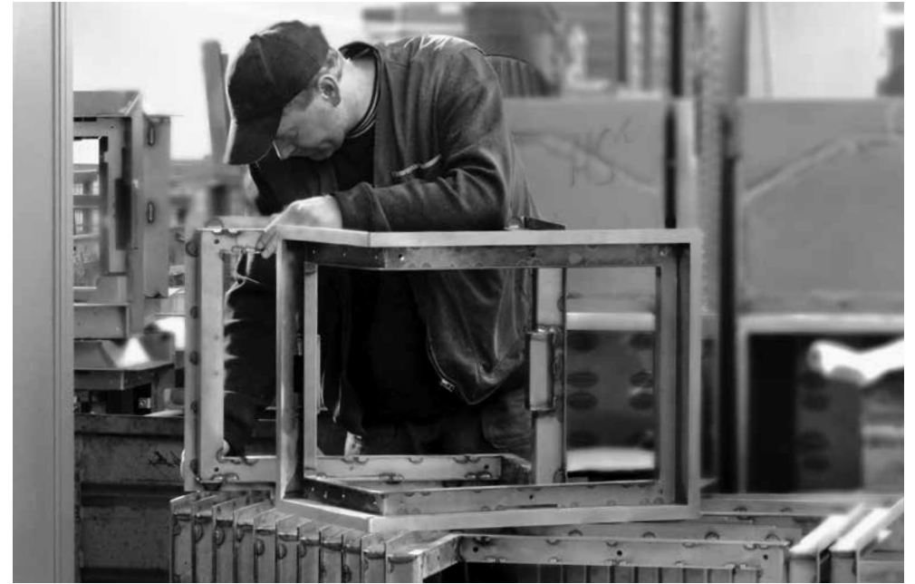
Montaggio dei componenti: personale tecnico specializzato monta ciascun focolare pezzo per pezzo fino a creare un assemblaggio di altissima qualità.
